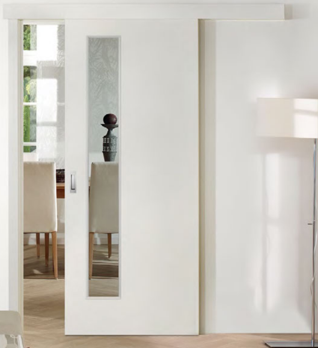
Schiebetür mit LA 44, Glas Float hell | Echtlack ähnl. RAL 9010 | Schiebetürzarge mit Schienenkasten auf der Wand, mit Einlaufblock
